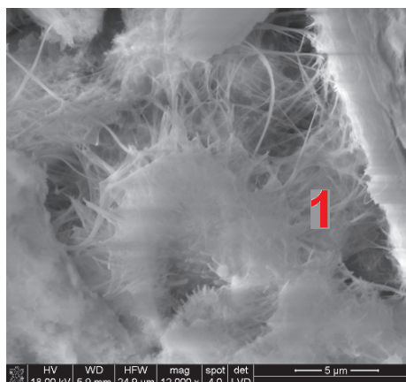
Rys. 11. Obraz mikrostruktury zaprawy z cementem żużlowo-wapiennym po 240 dniach oddziaływania \text{Na}_2\text{SO}_4 (1 – drobne igielki etryngitu) Fig. 11. Image of the microstructure of mortar with slag-limestone cement after 240 days of exposure to \text{Na}_2\text{SO}_4 solution (1 – tiny needles of ettringite)
