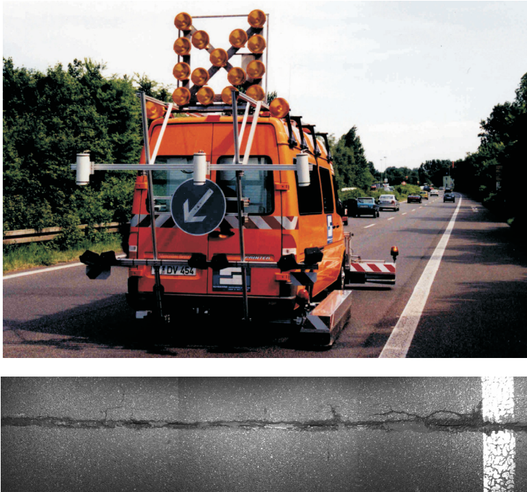
Rys. 3. Przykład zdjęcia, wykonanego z w celu identyfikacji cech powierzchniowych nawierzchni (źródło: Schniering Ing.-GmbH)
