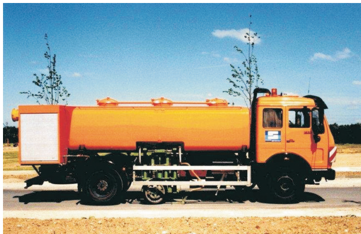
Rys. 2. Widok pojazdu pomiarowego SKM (źródło: Schniering Ing.-GmbH) Fig. 2. SKM measurement device (source: Schniering Ing.-GmbH)
