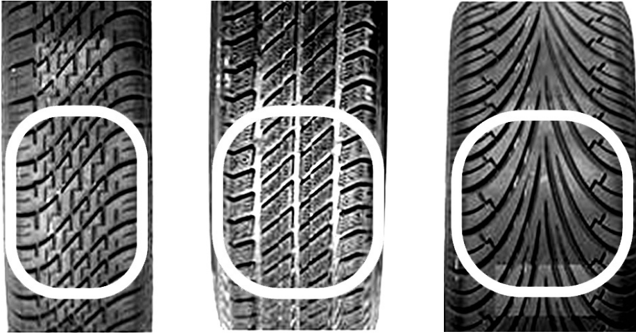
Rys. 2. Rowki bieżnika ukształtowane tak, aby jak najłagodniej wchodziły w ślad styku z nawierzchnią
