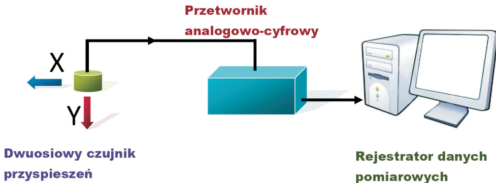
Rys. 3. Schemat układu pomiarowego na torze Fig. 3. Scheme of measurement systems on the track
