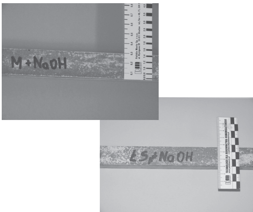
Rys.4. Belezki betonowe po 365 dniach przechowywaniu w łaźni Fig.4. Concrete bars after 365 days bath storage
