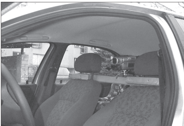
Rys.8. Mocowanie kamery rejestrującej w samochodzie Fig.8. The video-recorder fastening
