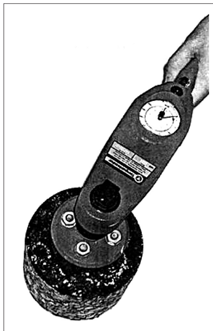
Rys.5. Aparat do badania połączenia metodą ścinania przy skręcaniu Fig.5. Interlayer bond evaluation device by shear at torsion test
