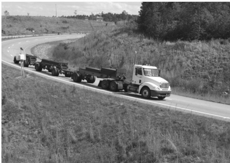
Rys.3. Pojazd w czasie przejazdu po torze badawczym NCAT Test Track [16] Fig.3. Test truck in operation on the NCAT Test Track [16]
