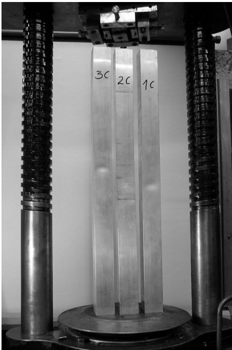
Rys.21. Widok wyboczenia kształtowników C Fig.21. Buckling of columns C
