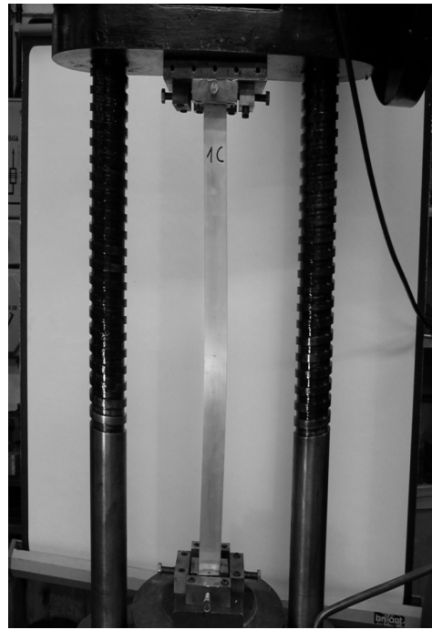
Rys.22. Widok wyboczenia kształtownika 1C Fig.22. Buckling of column 1C
