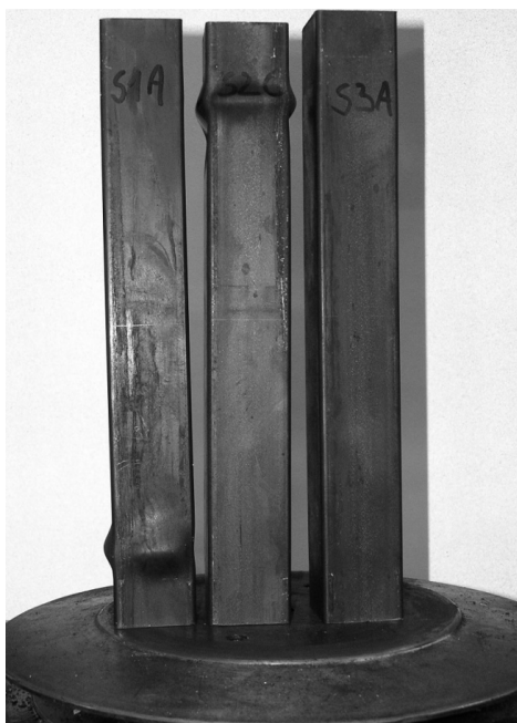
Rys.7. Widok wyboczenia kształtowników SA Fig.7. Buckling of columns SA
