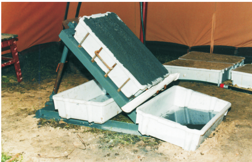
Rys.2. Stanowisko do badań zmywu erozyjnego gruntów
