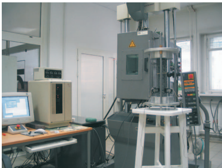
Rys.4. Próbka przygotowana do badania niskotemperaturowego TSRST w maszynie wytrzymałościowej MTS w IBDiM
