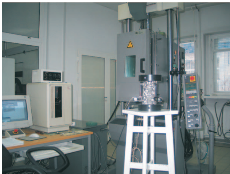
Rys.6. Próbkę przygotowaną do badania modułu zespolonego E^* w maszynie wytrzymałościowej MTS w IBDiM
