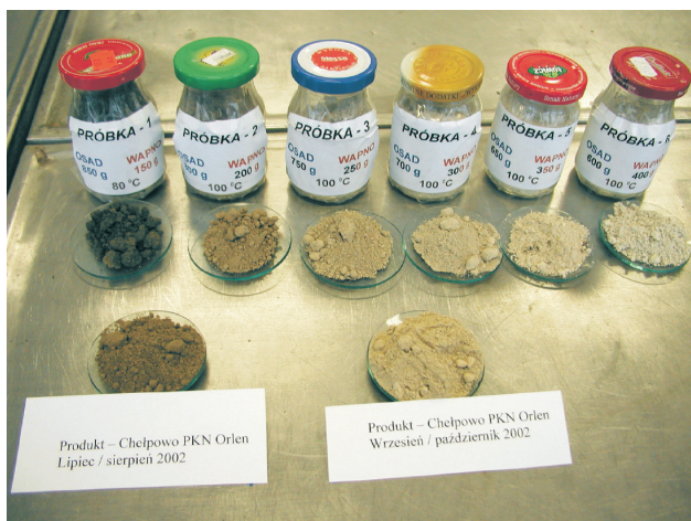
Rys.2. Wzorce o różnej zawartości CaO wykonane w Laboratorium IBDiM dla porównywania z produktem przetwarzania osadów uzyskiwanym w Płocku Fig.2. Reference samples with various CaO content obtained at IBDiM for a comparison with sludge processed in Płock
