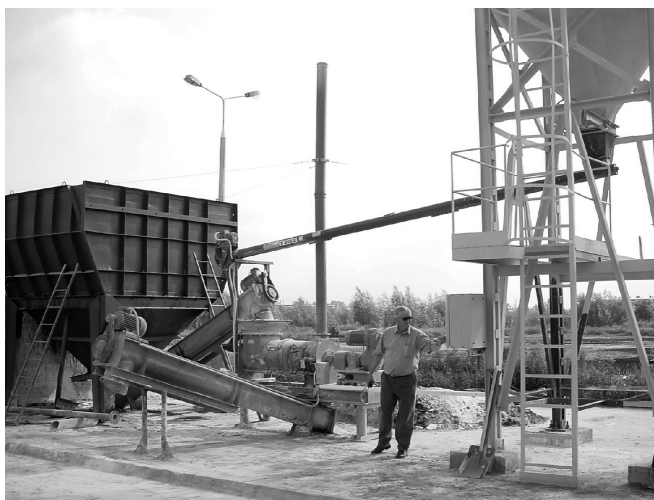
Rys.1. Instalacja tymczasowa do zestalenia osadów petrochemicznych ORTWED zainstalowana w Płocku
