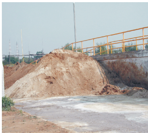
Rys.4. Zaolejone osady po przetworzeniu - faza stała Fig.4. Oily deposits after processing - solid phase
