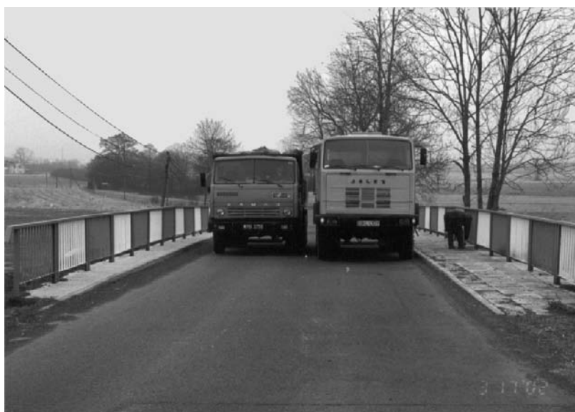
Rys.6. Widok od czoła na samochody obciążające most podczas wykonywania badań (III schemat obciążenia)
