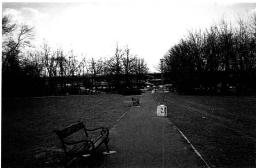
Rys.12. Krawężnik alejki jest prowadnicą dla niewidomych i niedowidzących. Ławki i kosze winny być usytuowane poza alejką. Warszawa, alejka w Parku Traugutta Fig.12. Kerb of the alley is a runner for the blinds. Benches and baskets should be situated beyond the alley. Warsaw, an alley in Park Traugutta
