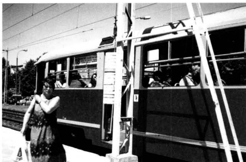
Rys.20. Przystanek tramwajowy. Słupy trakcyjne stojące w pasie bezpieczeństwa utrudniają wejście i wyjście z wagonu. Warszawa, ul. Woronicza
