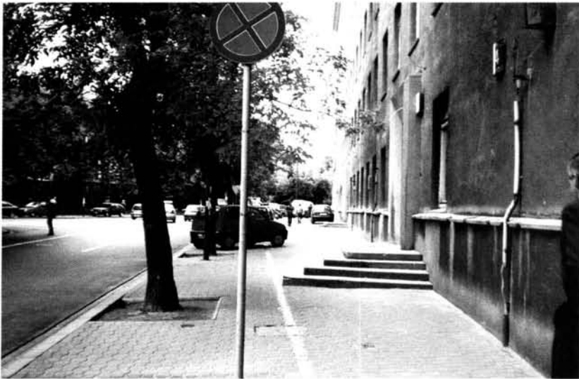
Rys.16. W razie zajęcia miejsca parkingowego przez samochody pieszy musi pokonywać przeszkodę. Dla niewidomych i osób poruszających się na wózkach jest to droga nie do przebycia
