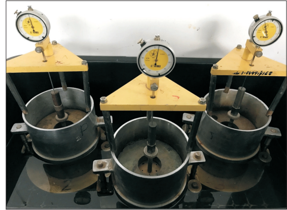
Fig. 26. Specimen conditioning before CBR testing Rys. 26. Widok próbek kondycjonowanych przed badaniem nośności CBR
