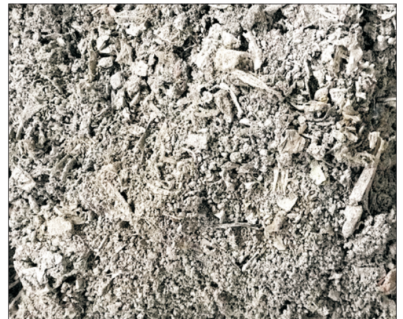
Fig. 3. Mixture of the 0/2 mm aggregate and the fragmented plastic waste Rys. 3. Mieszanka kruszywa 0/2 mm i rozdrobionych odpadów plastikowych
