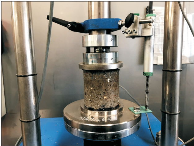
Fig. 10. Compressive strength testing Rys. 10. Badanie wytrzymałości na ściskanie
