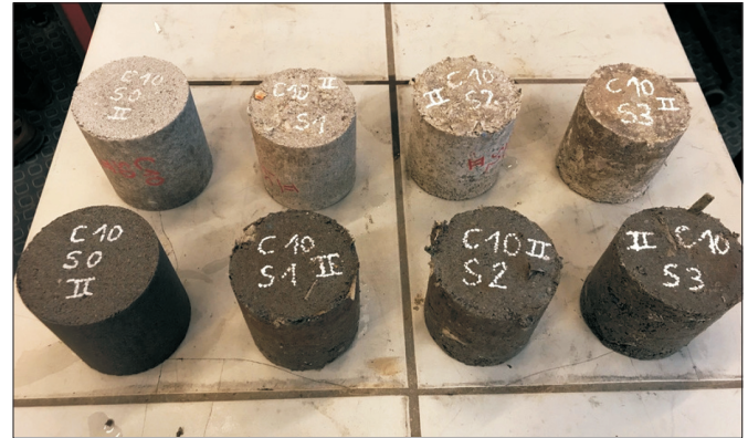
Fig. 20. An example batch of specimens before frost resistance testing – specimens after freeze-thaw cycles and specimens that were not subjected to freezing-thawing Rys. 20. Widok przykładowych partii próbek przed badaniem mrozoodporności – próbki poddane cyklowi zamrażania oraz próbki niepoddane zamrażaniu
