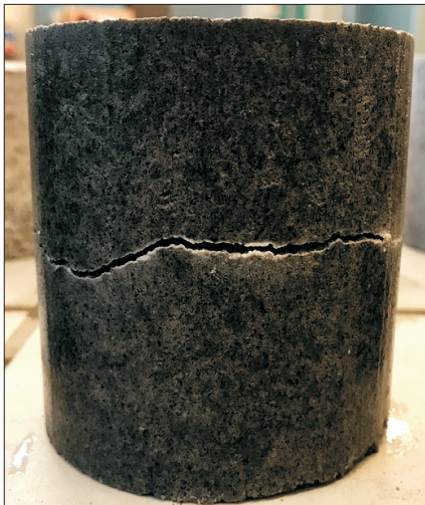
Fig. 23. Spontaneous cracking of a reference specimen with 10% cement content (without plastic waste) subjected to freezing Rys. 23. Samoczynne pęknięcie poddanej zamrażaniu próbki referencyjnej o zawartości cementu 10% (bez zawartości rozdrobnionych odpadów plastikowych)
