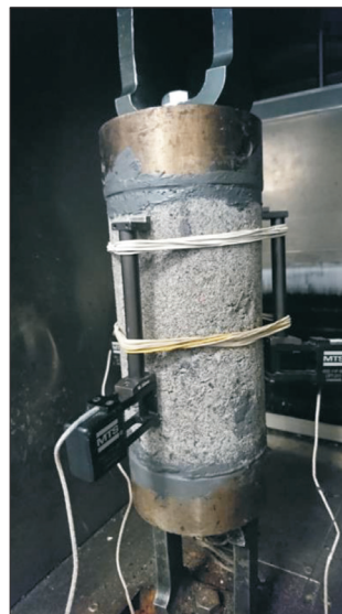
Fig. 11. Specimen fitted with extensometers and mounted in the loading device inside the thermostatic chamber Rys. 11. Widok przygotowanej próbki umieszczonej w komorze termostatującej i zamocowanej w uchwytach maszyny wytrzymałościowej wraz z czujnikami odkształceń
