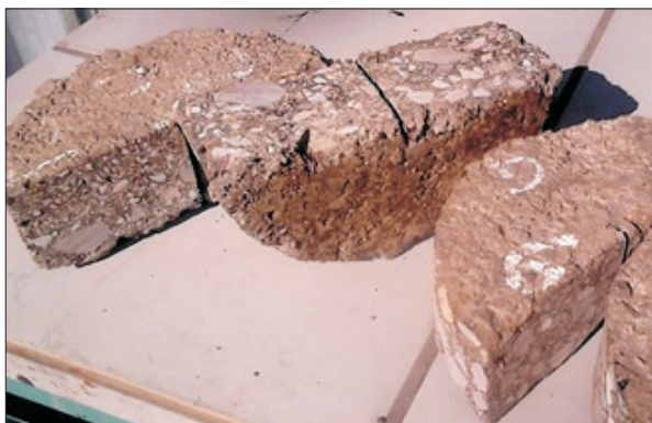
Fig. 5. Specimens prepared for SCB testing Rys. 5. Próbkę do badania metodą SCB
