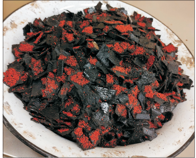
Fig. 1. Offcuts of asphalt shingles (RAS) used in the tests Rys. 1. Ścinki bitumicznych gontów papowych (RAS) przeznaczone do badania
