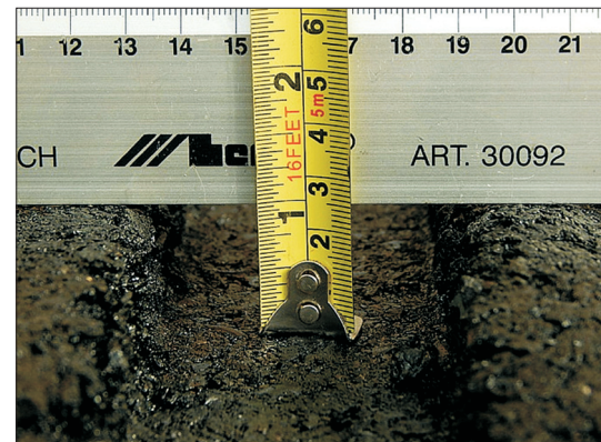
Fig. 9. Rutting test of the asphalt mixture with natural aggregate entirely replaced with polyamide aggregate Rys. 9. Badanie koleinowania mieszanki mineralno-asfaltowej, w której kruszywo naturalne zastąpiono w całości granulatem poliamidowym
