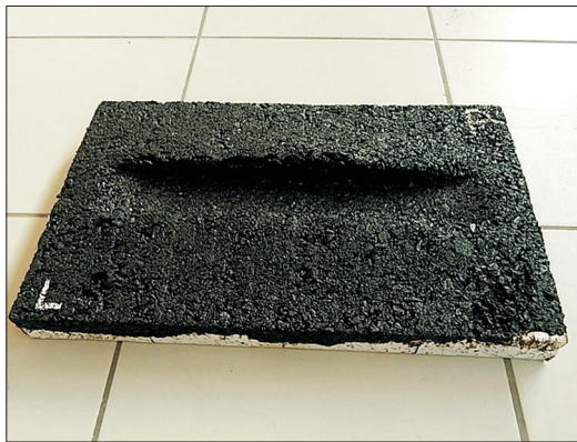
Fig. 9. Rutting test of the asphalt mixture with natural aggregate entirely replaced with polyamide aggregate Rys. 9. Badanie koleinowania mieszanki mineralno-asfaltowej, w której kruszywo naturalne zastąpiono w całości granulatem poliamidowym
