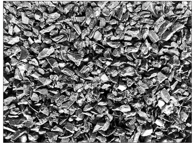
Fig. 7. Polyamide aggregate (PA66) for the asphalt mixture Rys. 7. Grysy poliamidowy (PA66) do mieszanki mineralno-asfaltowej
