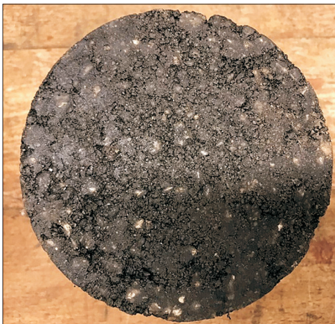
Fig. 8. AC8S asphalt mixture with polyamide aggregate (PA66) Rys. 8. Mieszanka mineralno-asfaltowa AC8S z granulem poliamidowym (PA66)
