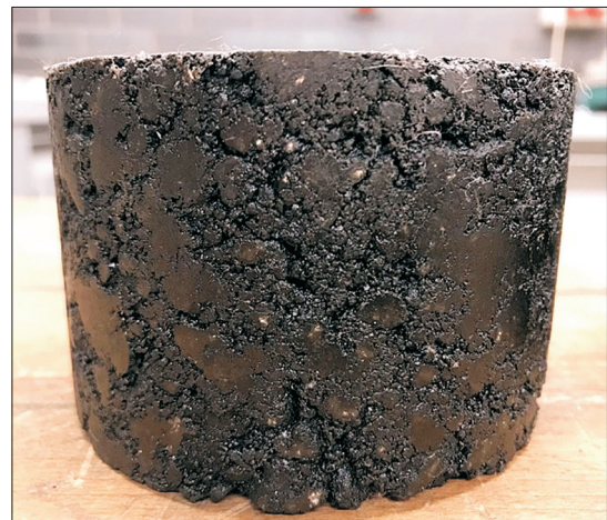
Fig. 8. AC8S asphalt mixture with polyamide aggregate (PA66) Rys. 8. Mieszanka mineralno-asfaltowa AC8S z granulem poliamidowym (PA66)
