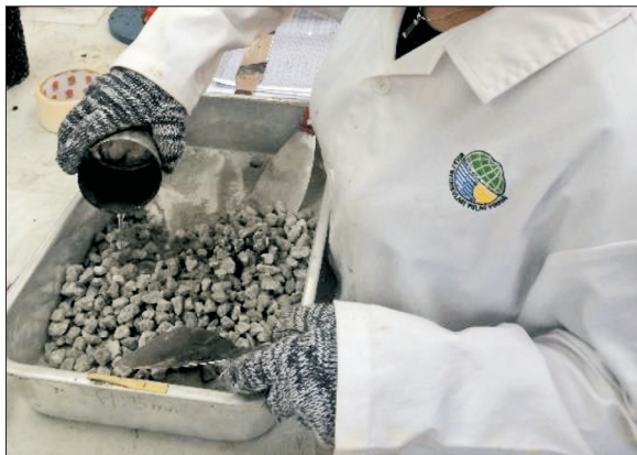
Fig. 2. Mixing of aggregate and cement with water Rys. 2. Mieszanie kruszywa i cementu z wodą
