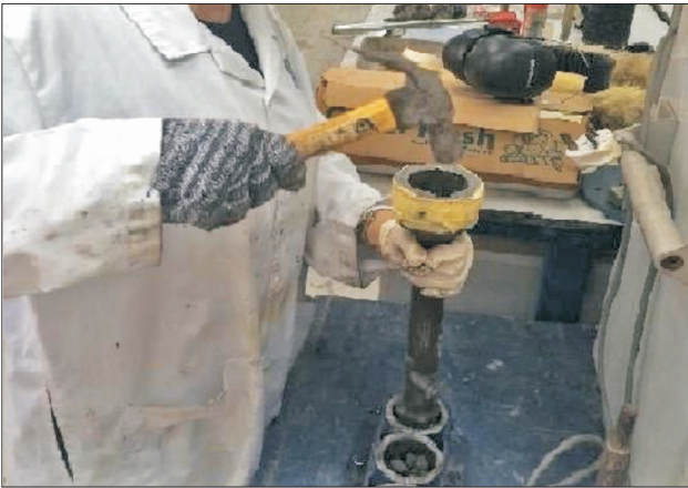
Fig. 3. Preparation of samples Rys. 3. Formowanie próbek
