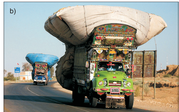
Fig. 2. Overloaded trucks (2-axle Bedford) hauling over National Highway N-5: a) loaded with wheat grain sacks having GVW = 325 kN (approx.), b) loaded with wheat straw having GVW = 245 kN (approx.); GVW – Gross Vehicle Weight Rys. 2. Przeladowane pojazdy ciężarowe (2-osiowy Bedford) na drodze krajowej N-5 przewożące: a) worki ze zbożem o obciążeniu całkowitym ok. 325 kN, b) worki ze słomą pszenną o obciążeniu całkowitym ok. 245 kN
