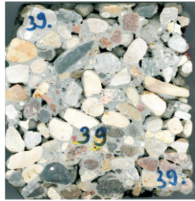
Fig. 9. Section through concrete design no. 39 Rys. 9. Przekrój próbki o składzie nr 39
