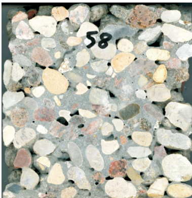
Fig. 12. Section through concrete design no. 58 Rys. 12. Przekrój próbki o składzie nr 58
