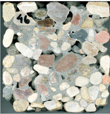
Fig. 10. Section through concrete design no. 46 Rys. 10. Przekrój próbki o składzie nr 46
