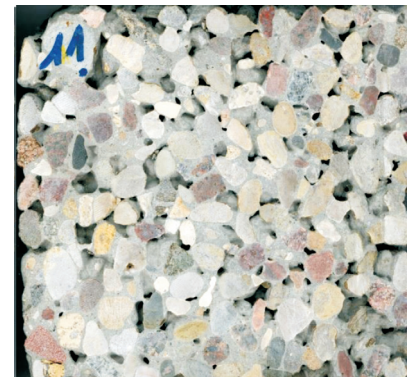
Fig. 5. Section through concrete design no. 11 Rys. 5. Przekrój próbki o składzie nr 11
