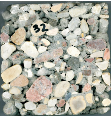
Fig. 8. Section through concrete design no. 32 Rys. 8. Przekrój próbki o składzie nr 32
