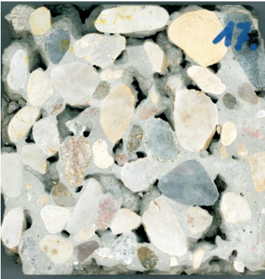
Fig. 6. Section through concrete design no. 17 Rys. 6. Przekrój próbki o składzie nr 17
