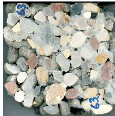
Fig. 13. Section through concrete design no. 63 Rys. 13. Przekrój próbki o składzie nr 63
