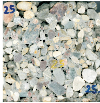
Fig. 7. Section through concrete design no. 25 Rys. 7. Przekrój próbki o składzie nr 25
