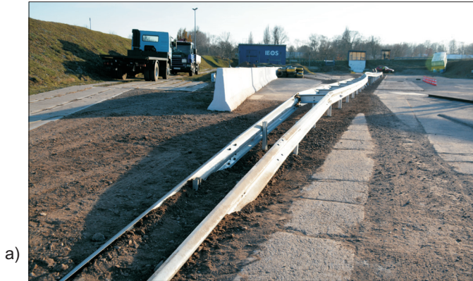
Fig. 3. View of the barrier after the second impact (a) showing visible damage at the location of vehicle collision (b) Rys. 3. Widok bariery po drugim uderzeniu (a) ze szczegółami zniszczeń w miejscu najechania przez pojazd (b)
