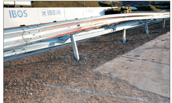
Fig. 3. View of the barrier after the second impact (a) showing visible damage at the location of vehicle collision (b) Rys. 3. Widok bariery po drugim uderzeniu (a) ze szczegółami zniszczeń w miejscu najechania przez pojazd (b)
