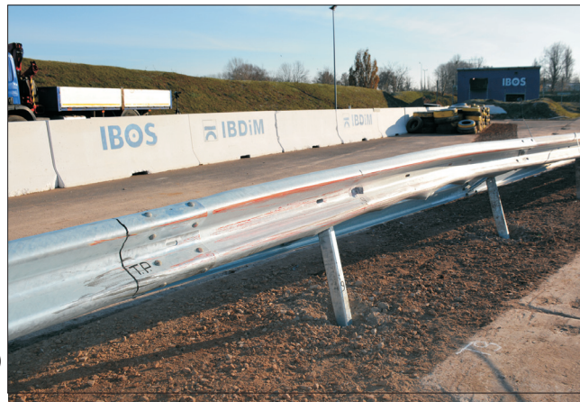
Fig. 2. View of the barrier after the first impact (a) showing visible damage at the location of vehicle collision (b) Rys. 2. Widok bariery po pierwszym uderzeniu (a) ze szczegółami zniszczeń w miejscu najechania przez pojazd (b)
