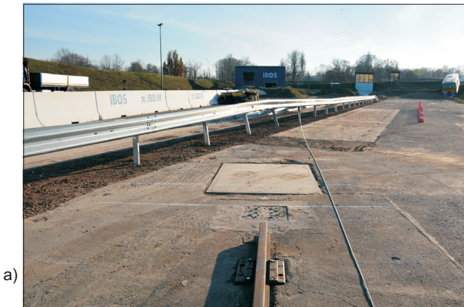
Fig. 2. View of the barrier after the first impact (a) showing visible damage at the location of vehicle collision (b) Rys. 2. Widok bariery po pierwszym uderzeniu (a) ze szczegółami zniszczeń w miejscu najechania przez pojazd (b)
