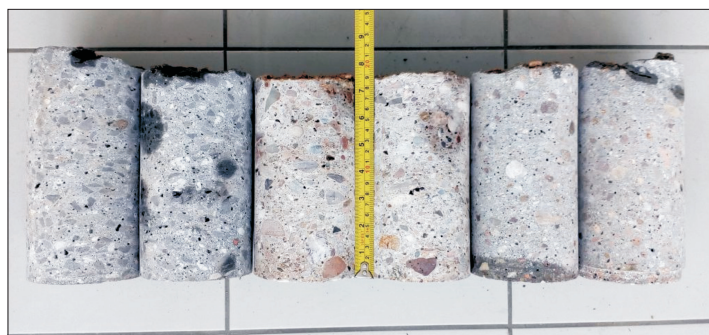
Fig. 1. Concrete cores bored out from slabs Rys. 1. Widok rdzeni betonowych z odwiertów płyt
