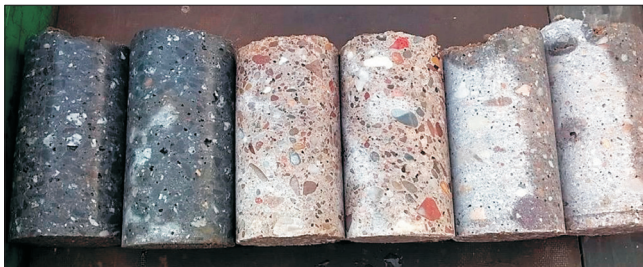
Fig. 4. Concrete cores bored out from slabs Rys. 4. Widok rdzeni betonowych odwierconych z płyt
