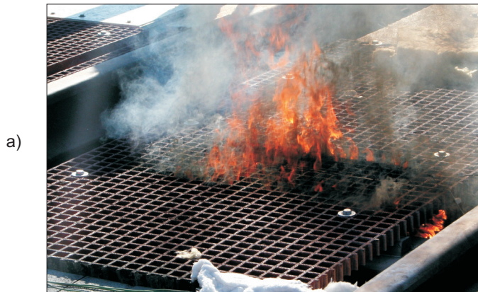
Fig. 8. a) The FRP grid floor in field 3 during the fire test, b) Gas temperature measured below the FRP grid in field 3 - TC8 located close to the rail, TC9 between the FRP grid and a wooden sleeper Rys. 8. a) Wypełnienie z krat FRP w polu 3 w trakcie oddziaływania ognia, b) Temperatura gazów mierzona pod wypełnieniem z krat FRP w polu 3 za pomocą termopary TC8 umieszczonej przy szynie oraz termopary TC9 umieszczonej między kratą FRP i drewnianym podkładem
