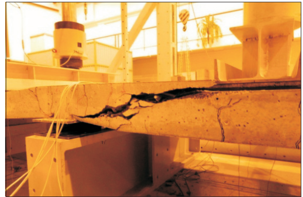
Fig. 5. Failure modes of the tested deck slabs Rys. 5. Postacie zniszczenia badanych płyt pomostowych
