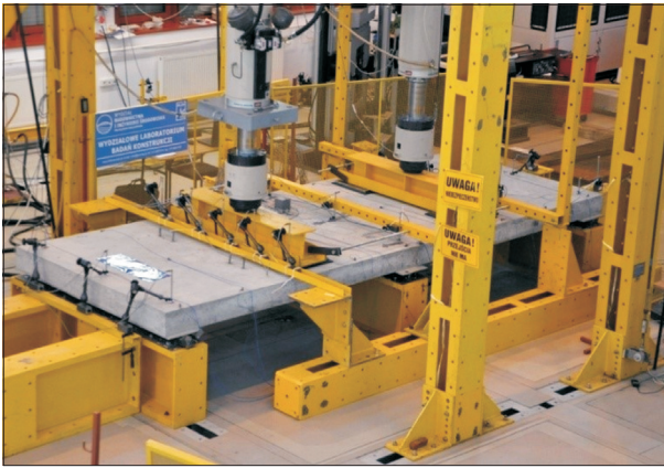
Fig. 4. Deck slab during structural tests Rys. 4. Płyta pomostu podczas badań wytrzymałościowych
