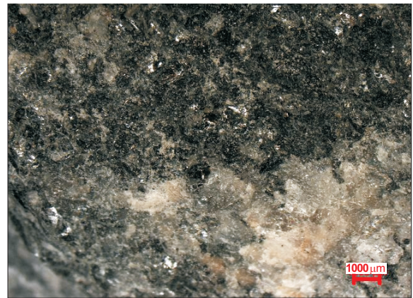
Fig. 7. Biotite granite (stereoscopic image on the right) Rys. 7. Granit biotytowy (po prawej obraz z mikroskopu stereoskopowego)
