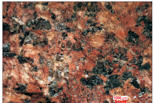
Fig. 4. Porphyritic granite (stereoscopic image on the right) Rys. 4. Granit o strukturze porfirowatej (po prawej obraz z mikroskopu stereoskopowego)
