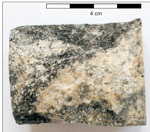
Fig. 7. Biotite granite (stereoscopic image on the right) Rys. 7. Granit biotytowy (po prawej obraz z mikroskopu stereoskopowego)
