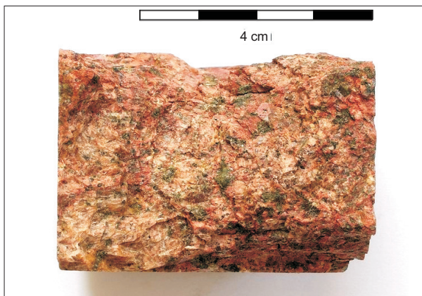
Fig. 4. Porphyritic granite (stereoscopic image on the right) Rys. 4. Granit o strukturze porfirowatej (po prawej obraz z mikroskopu stereoskopowego)
