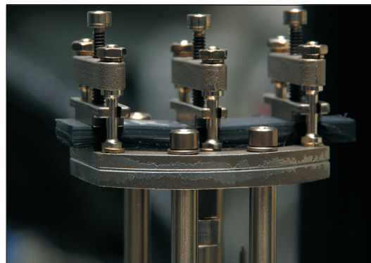
Fig. 2. Elastomer specimen fitted in double cantilever clamp Rys. 2. Próbkę elastomerową zamontowaną w uchwycie typu „podwójny wspornik”
