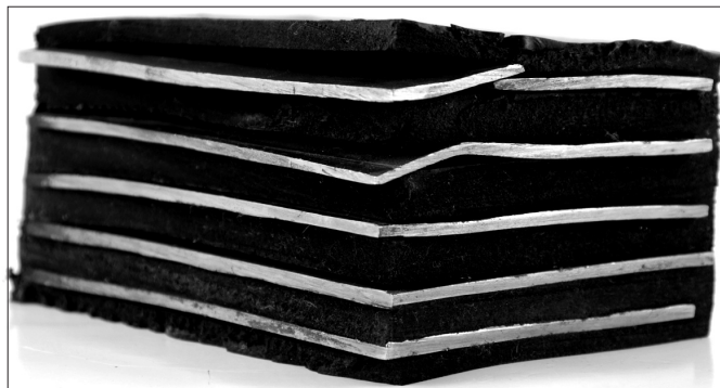
Fig. 1. Part of 9W elastomeric bearing subjected to compression test in 1987 – state in April 2015; the photo in figure 7 in [22] Rys. 1. Część łożyska elastomerowego 9W poddanego badaniu nośności na ściskanie w roku 1987 – stan w kwietniu 2015 r.; zdjęcie zamieszczone na rysunku 7 w [22]
