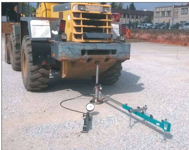
Fig. 2. View of the static (a) and dynamic (b) plate load tests Rys. 2. Widok badania płytą statyczną VSS (a) oraz płytą dynamiczną LPD (b)
