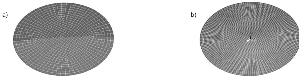
Fig. 2. Finite element model of conical shell built of N = 768 (a) and N = 3888 (b) elements Rys. 2. Model MES powłoki stożkowej złożony z N = 768 (a) i N = 3888 (b) elementów
