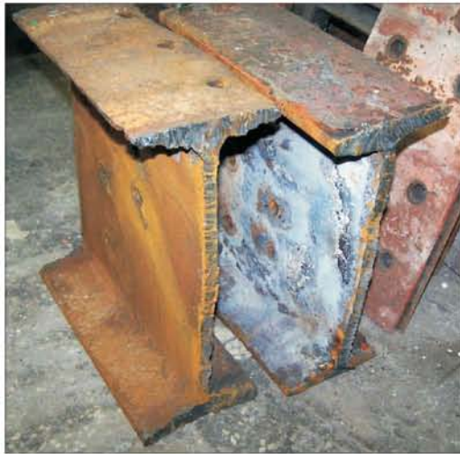
Fig. 5. View of the samples from two stringers for testing Rys. 5. Widok odcinków dwóch podłużnic do badań
