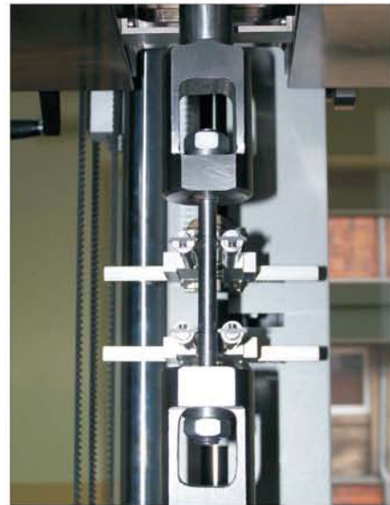
Fig. 6. Steel specimen in tensile strength test Rys. 6. Próbką stalowa w badaniu wytrzymałości na rozciąganie
