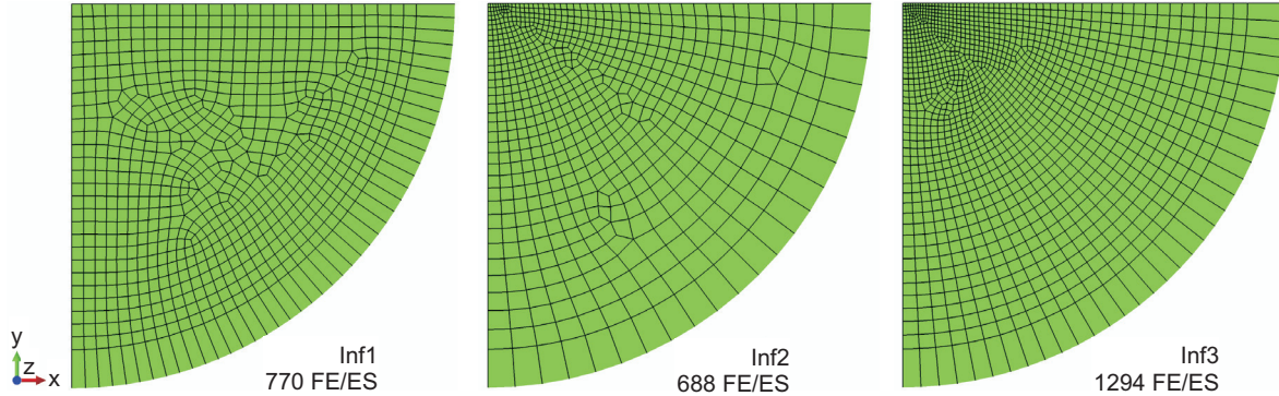
Fig. 16. The general view of hemispherical infinite element models Rys. 16. Widok ogólny modeli w kształcie półkuli z elementami nieskończonymi
