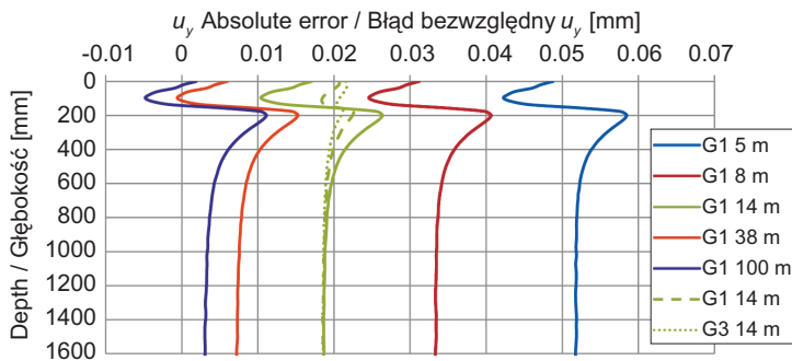
Fig. 8. The absolute error of vertical displacement u_y in hemispherical models Rys. 8. Błąd bezwzględny przemieszczenia pionowego u_y w modelach w kształcie półkuli
