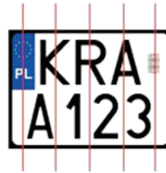
Fig. 5. Static borders imposed on a double-row license plate area Rys. 5. Granice statyczne nałożone na obszar tablicy rejestracyjnej dwurzędowej
