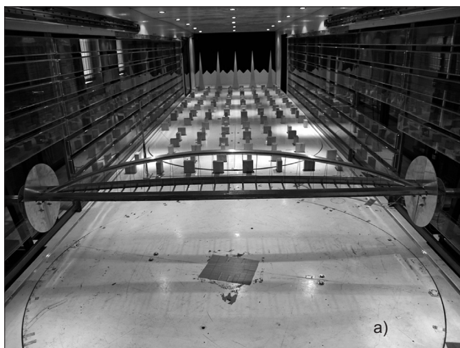
Fig. 3. View of the models attached in the wind tunnel test section: a) model of the entire bridge, b) one of section models Rys. 3. Widok modeli ustawionych w przestrzeni pomiarowej tunelu aerodynamicznego: a) model całego mostu, b) jeden z modeli sekcyjnych
