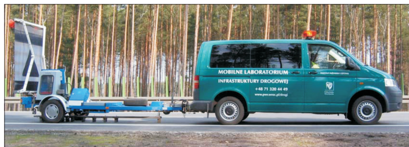
Fig. 1. View of the Dynatest FWD 8002 testing device Rys. 1. Widok urządzenia FWD 8002 firmy Dynatest
