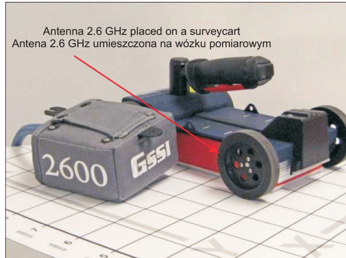
Fig. 1. Typical GPR System with 2.6 GHz antenna from GSSI Rys. 1. Typowy system radarowy GPR z anteną 2,6 GHz firmy GSSI
