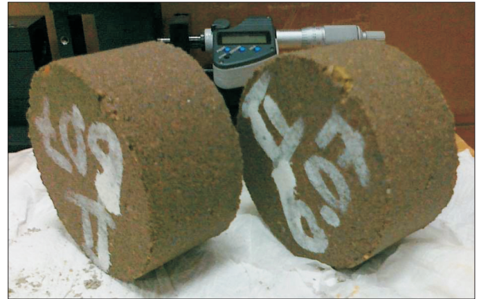
Fig. 1. Specimens used for determination of resilient modulus Rys. 1. Próbkę użyte do badania modułu sprężystości
