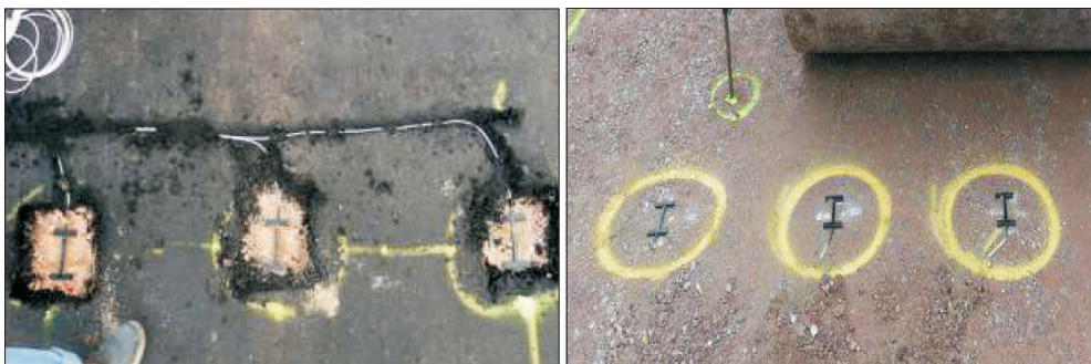
Rys. 4. Czujniki odkształceń poziomych na warstwie podbudowy z kruszywa łamanego stabilizowanego mechanicznie Fig. 4. Horizontal strain sensors at the top of sub-base made of stabilized crushed aggregate
