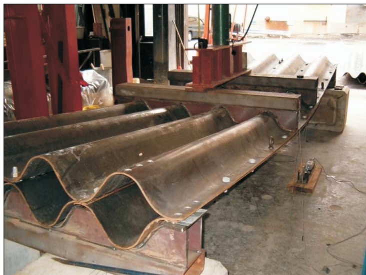
Rys. 14. Widok stanowiska badanej płyty warstwowej [5] Fig. 14. A view of test stand for layered plates [5]
