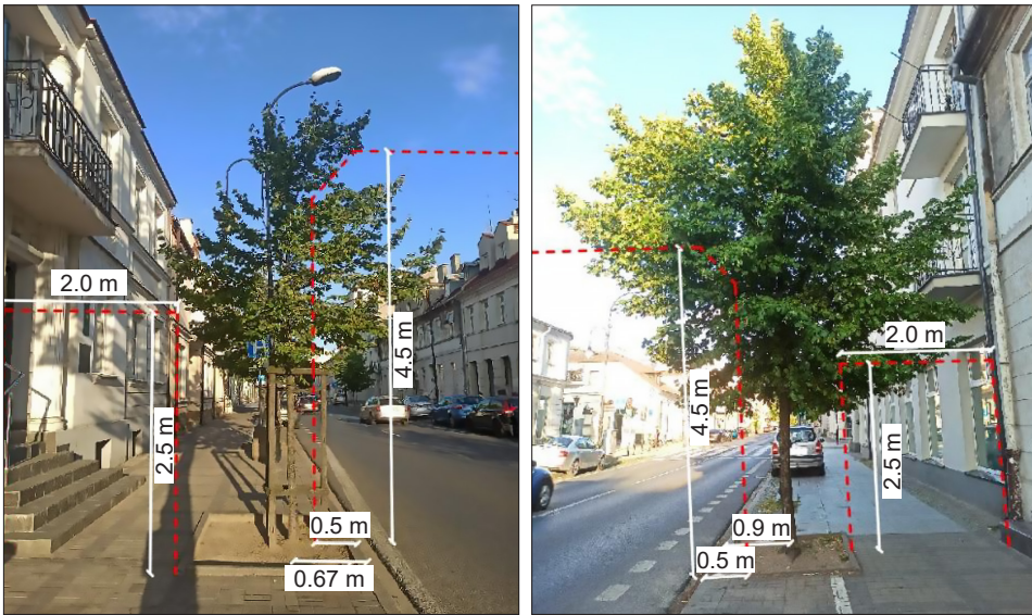
Fig. 2. Examples of interference of young trees crown with the clearance Rys. 2. Przykłady ingerencji korony młodych drzew w skrajnie
