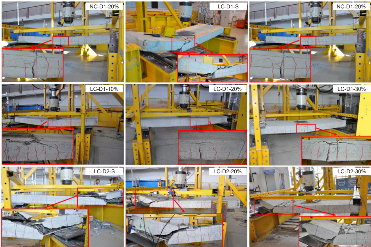
Fig. 9. Failure modes of the tested slabs Rys. 9. Postacie zniszczenia badanych płyt
