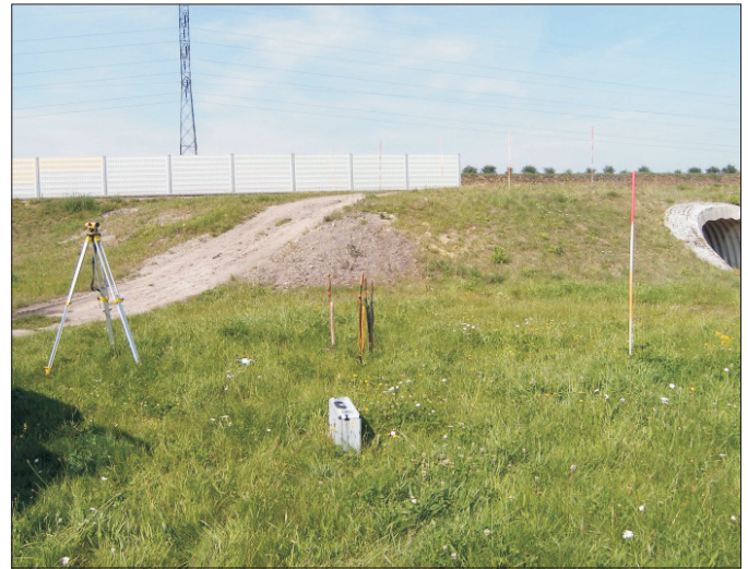
Fig. 4. View of the leveling rods arrangement outlining the axis of the culvert and the measurement points Rys. 4. Widok na rozmieszczenie tyczek niwelacyjnych wyznaczających oś przepustu i punkty pomiarowe
